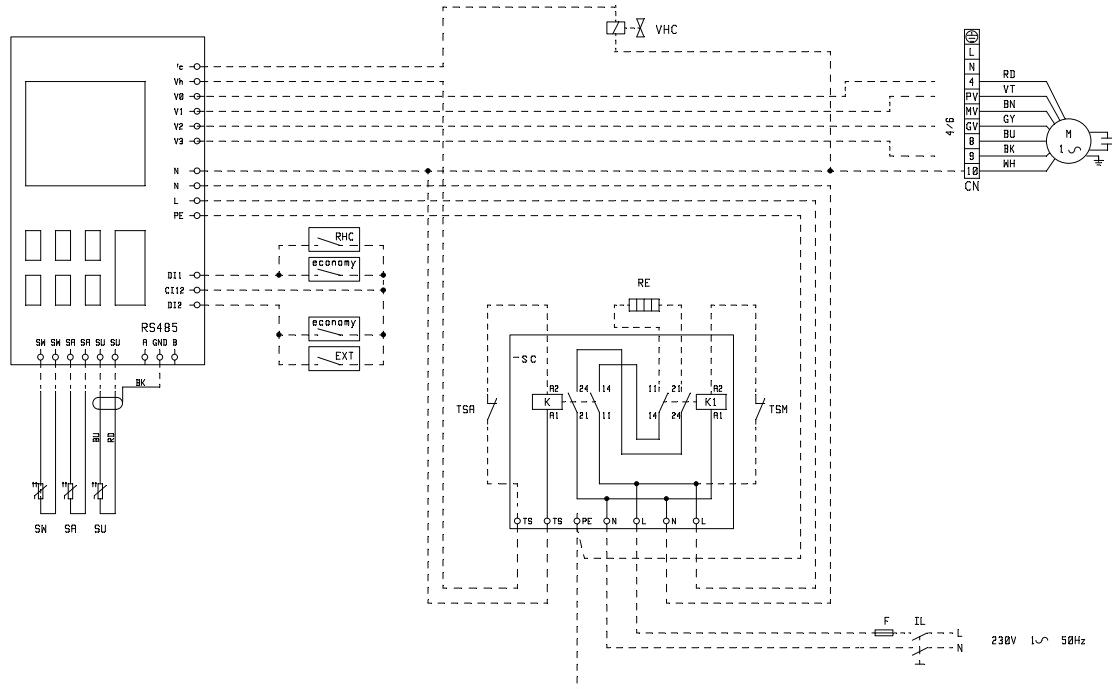
» Electrical connection FWEC2A/3A + FWB-C 05-11 + valve + heating element - Collegamento elettrico FWEC2A/3A + FWB-C 05-11 + valvola + resistenza elettrica - Branchement électrique FWEC2A/3A + FWB-C 05-11 + vanne + résistance électrique - Elektrischer Anschluss FWEC2A/3A + FWB-C 05-11 + ventil + elektrischer Widerstand - Conexión eléctrica FWEC2A/3A + FWB-C 05-11 + valvula + resistencia eléctrica
