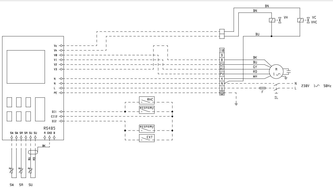
» Electrical connection FWEC1A + FWB-C 04 + valve + heating element - Collegamento elettrico FWEC1A + FWB-C 04 + valvola + resistenza elettrica - Branchement électrique FWEC1A + FWB-C 04 + vanne + résistance électrique - Elektrischer Anschluss FWEC1A + FWB-C 04 + ventil + elektrischer Widerstand - Conexión eléctrica FWEC1A + FWB-C 04 + valvula + resistencia eléctrica
