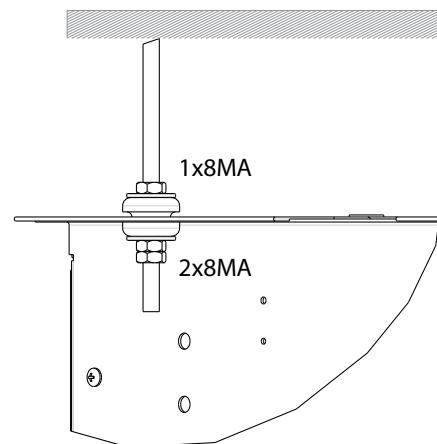
» Condensate discharge proper inclination - Pendenza corretta per scarico condensa - Inclinaison correcte pour la purge de condensat - Kondenswasserablass korrekte Neigung - Pendiente correcta para la descarga del condensad
