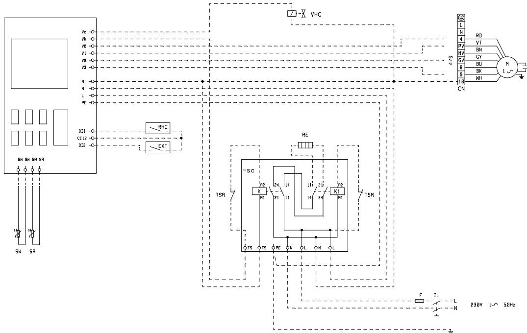
» Electrical connection FWEC1A + FWB-C 5-11 + valve + heating element - Collegamento elettrico FWEC1A + FWB-C 5-11 + valvola + resistenza elettrica - Branchement électrique FWEC1A + FWB-C 5-11 + vanne + résistance électrique - Elektrischer Anschluss FWEC1A + FWB-C 5-11 + ventil + elektrischer Widerstand - Conexión eléctrica FWEC1A + FWB-C 5-11 + valvula + resistencia eléctrica
