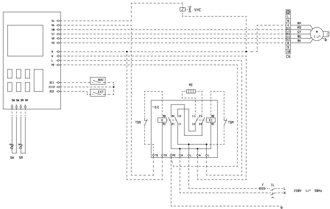
» Electrical connection FWEC2A/3A + FWB-C 04 + valve + heating element - Collegamento elettrico FWEC2A/3A + FWB-C 04 + valvola + resistenza elettrica - Branchement électrique FWEC2A/3A + FWB-C 04 + vanne + résistance électrique - Elektrischer Anschluss FWEC2A/3A + FWB-C 04 + ventil + elektrischer Widerstand - Conexión eléctrica FWEC2A/3A + FWB-C 04 + valvula + resistencia eléctrica
