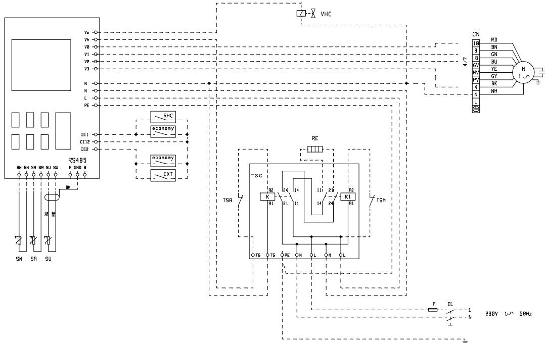
» Electrical connection FWEC2A/3A + FWB-C15-17 + valve + heating element - Collegamento elettrico FWEC2A/3A + FWB-C 15-17 + valvola + resistenza elettrica - Branchement électrique FWEC2A/3A + FWB-C 15-17 + vanne + résistance électrique - Elektrischer Anschluss FWEC2A/3A + FWB-C 15-17 + ventil + elektrischer Widerstand - Conexión eléctrica FWEC2A/3A + FWB-C 15-17 + valvula + resistencia eléctrica
