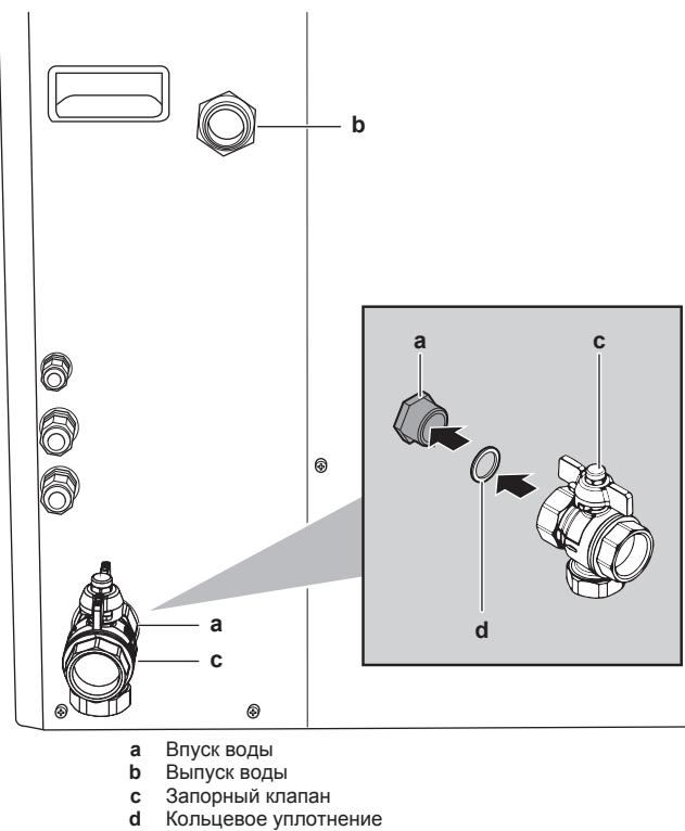
8 Подсоедините трубопроводы входа и выхода горячей воды бытового потребления к внутреннему агрегату.
