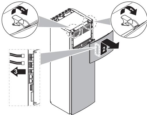
3 При необходимости снимите переднюю панель. Это требуется, например, в следующих случаях:
