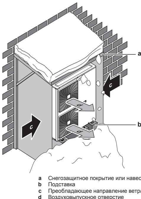
В любом случае предусмотрите под блоком не менее 150 мм свободного пространства. Кроме того, убедитесь в том, что блок расположен по крайней мере на 100 мм выше предполагаемого максимального уровня поверхности снежного покрова. Дополнительные сведения приведены в разделе «[7.3 Монтаж наружного агрегата](#)» на стр. 29.
