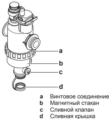
Ежегодное техническое обслуживание магнитного фильтра/отделителя загрязнений включает:
