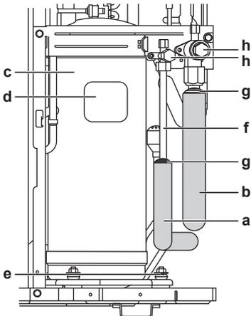
6 Если наружный блок установлен выше внутреннего, закройте запорные клапаны (h, см. выше) герметичным материалом во избежание просачивания конденсата с запорных клапанов во внутренний блок.
