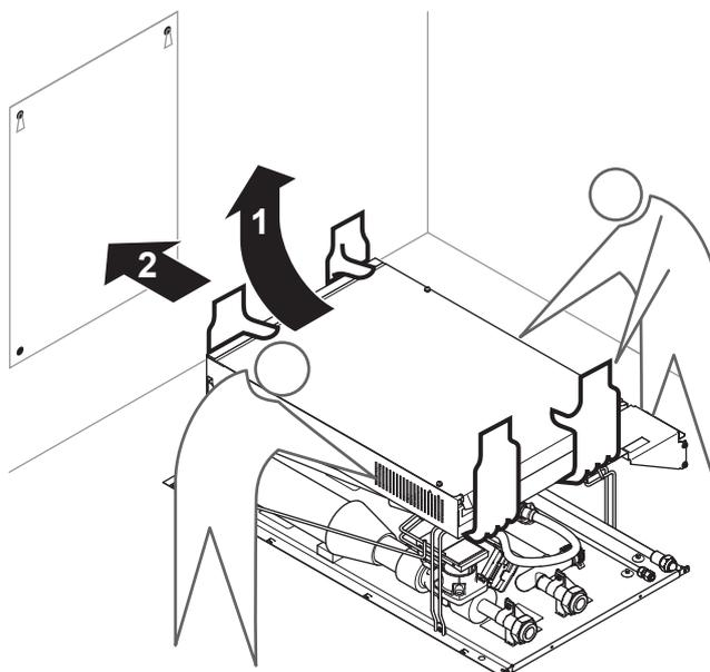
5 Наклоните верх агрегата к стене в месте, где вставлены 2 винта.
