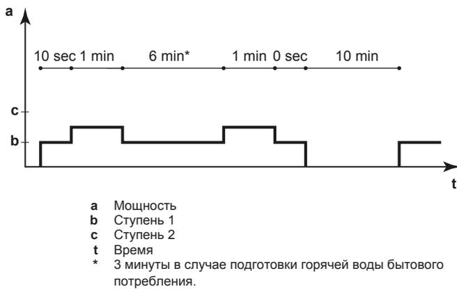
**Рис. 3. Вспомогательный нагреватель (ЕКНВ), минимальная временная задержка между ступенями**
