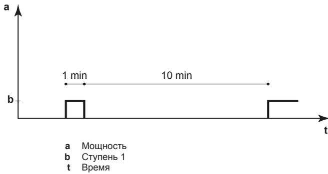
**Рис. 2. Резервный нагреватель (\*9W), минимальная временная задержка между ступенями**
