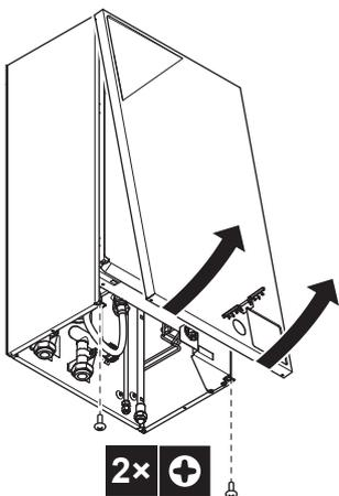
2 Наклоните переднюю панель к себе и снимите ее.
