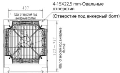
Примечание) 1. Для передней и нижней стороны размеры указаны после крепления подсоединенного трубопровода.
