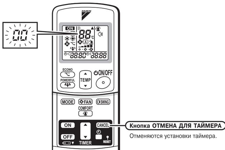
2. Нажмите кнопку отмены таймера несколько раз, до тех пор, пока не будет слышна длительная звуковая посылка.
