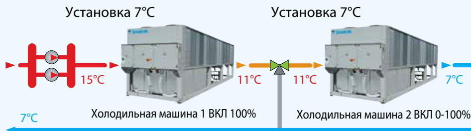
РИС. 3: ПОСЛЕДОВАТЕЛЬНАЯ КОНФИГУРАЦИЯ ДВУХ ХОЛОДИЛЬНЫХ МАШИН
