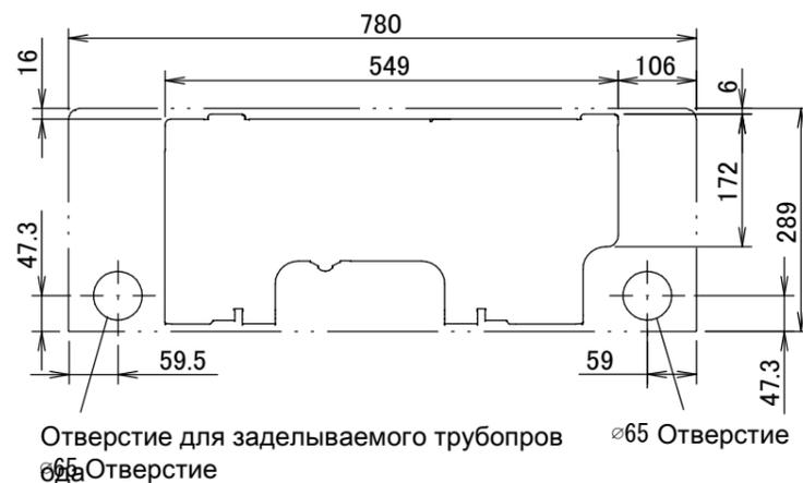
Отверстие для заделываемого трубопровод
