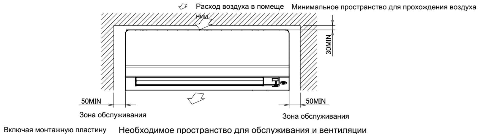
Включая монтажную пластину **Необходимое пространство для обслуживания и вентиляции**
